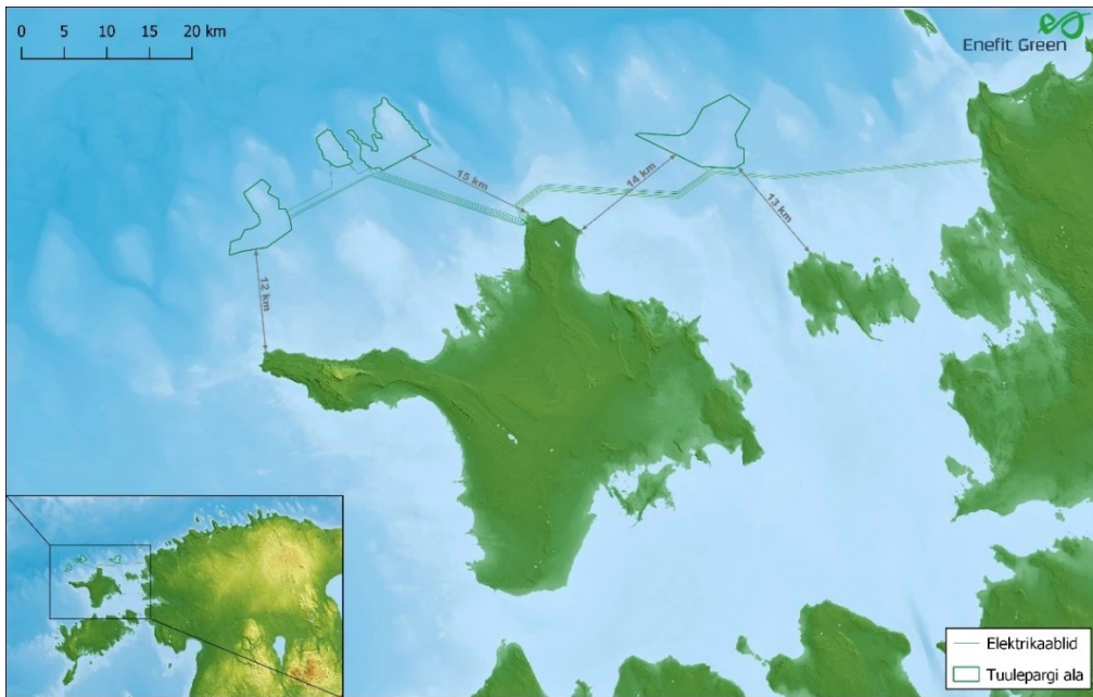
Joonis 15. Hiiu meretuulepargi skeem koos perspektiivsete merekaabelühendustega Aulepa alajaama suunal (Enefit Green AS).
