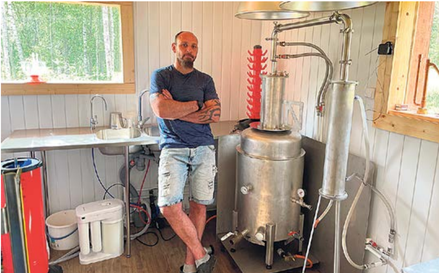
Džinni valmistamiseks vajaliku destillaatori töötas välja ja tegi valmis Reimo ise. Foto: Kärolyn Kivistik
