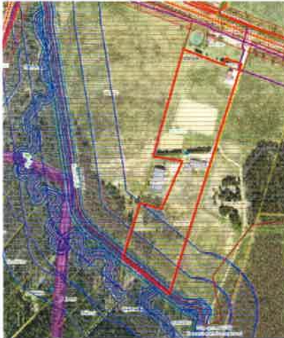
Joonis 3. Elektrimaakaabelliini, Nuutri jõe ja maaparandussüsteemi põhjustatud kitsendused planeeringualal (väljavõte Maa-ameti kitsenduste kaardist).
