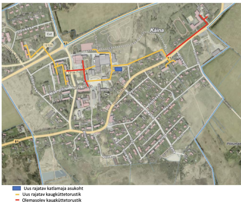
Joonis 8. Käina aleviku uue hakkpuidul töötava katlamaja ja kaugküttevõrgu informatiivne skemaatiline lahendus
